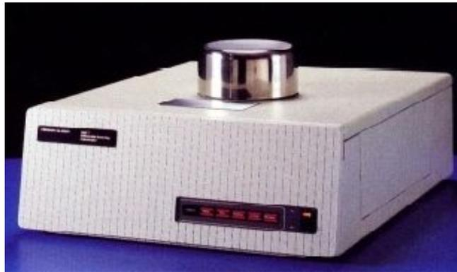
**Figure II-11:** DSC7 de Perkin-Elmer
