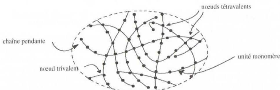
**Figure I-12** : Représentation schématique d'un polymère tridimensionnel [10]
