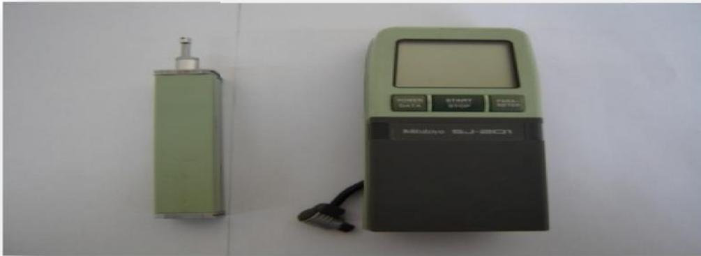
**Figure II-22- Rugosimètre (2D) SurfTest 201 (Mitutoyo)**
