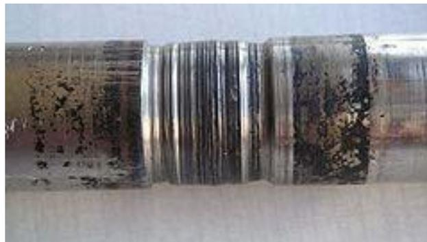
**Fig.I-4:** Conséquence de l'usure par abrasion
