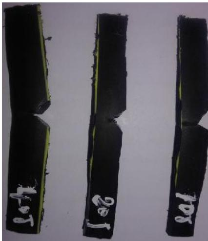
Figure III.13 : photo échantillon vieilli Sous eau chaude de tube de gaz
