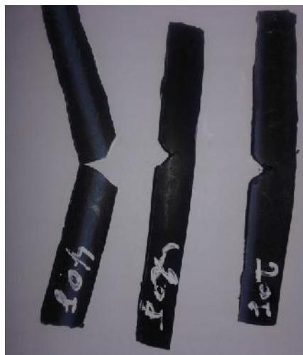
Figure III.14 : photo échantillon vieilli Sous eau chaude de tube de PVC
