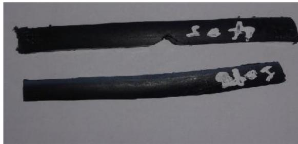
**Figure III.18 : Photo échantillon vieilli pour le tube de PEHD en entaille et non entaille**
