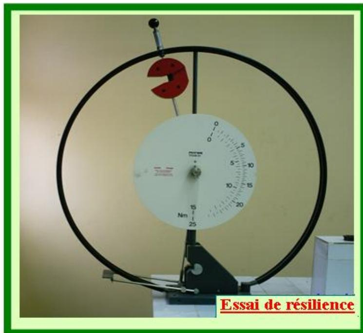
**Figure III.4 : Machine d'essai de choc Charpy**
