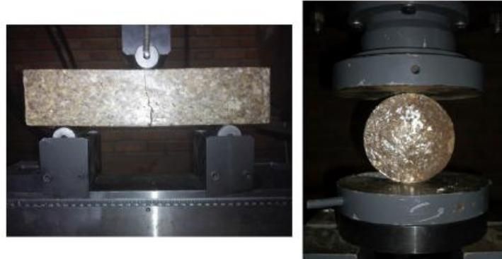
**Fig. 1 :** Les essais de flexion et de Disc brésilien.
