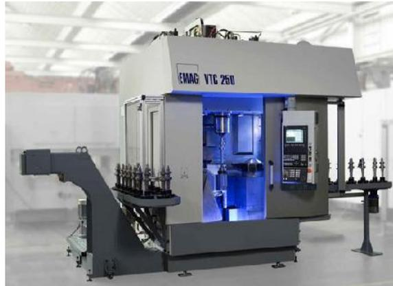
**Fig. I.4 :** un bâti d'une machine de tournage en béton polymère. [6]
