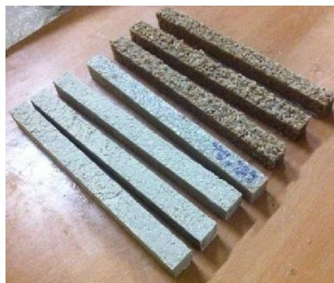
**Fig. II.9 :** Échantillons prismatiques en BR.
