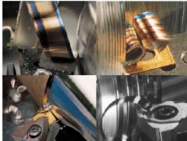
Figure I.3 : Différentes opérations de tournage industriel [4].
