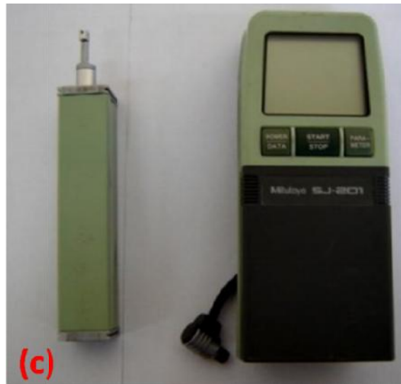
Figure II.8 : Mesure de la rugosité.
