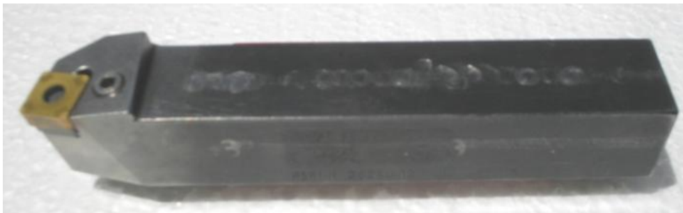
Figure II.3: Porte outil utilisé.
