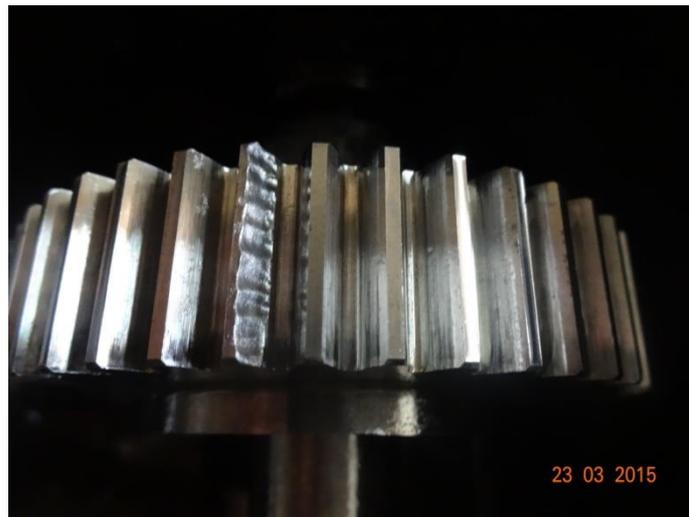
*Figure II.4: Le Défaut crée sur tout le largeur de la dent*
