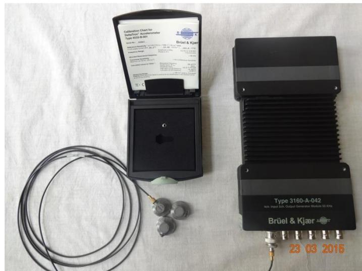
*Figure II. 2: Photo du Pulse type Brüel & Kjær «3610-A-042» et les trois accéléromètres type «4513-B-001»*
