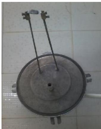
**Figure 2.4:** Position de la plaque de graphite avant la réaction SHS
