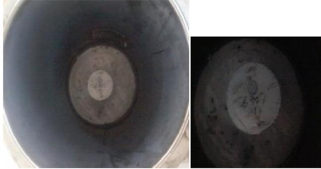
**Figure 2.5 :** l'échantillon est mise dans le creuse avant la réaction.
