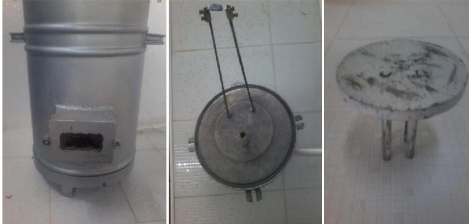
**Figure 2.3:** les parties qui composent le système de combustion en Mode SHS
