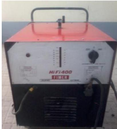
**Figure1.4** : poste à souder avec une intensité de soudage maximale de 400Ampère.
