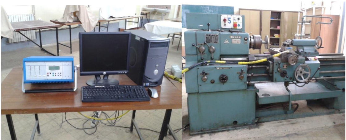
Figure 3.3. Montage expérimental pour la mesure des efforts de coupe
