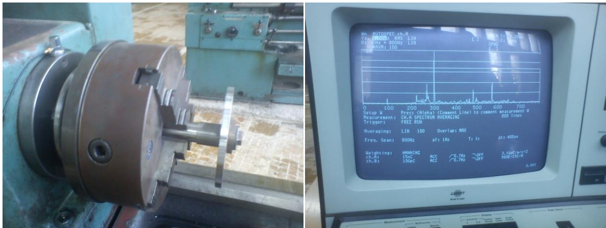
Figure 2.10. Montage expérimental pour la mesure vibratoire
