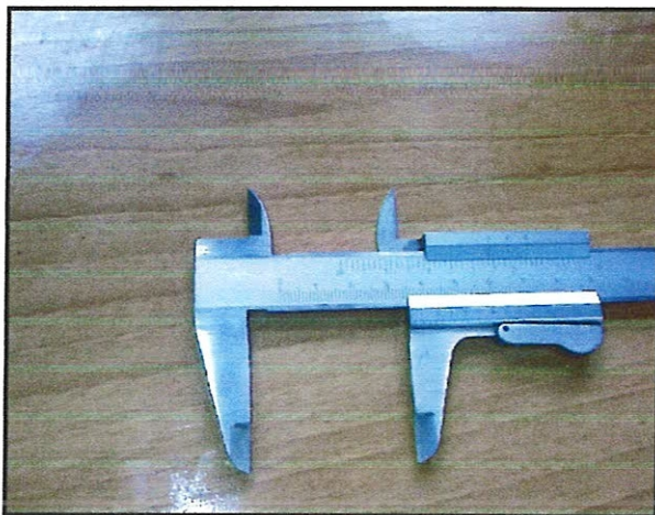
Photo II-4 : Mesure du retrait et gonflement par l'intermédiaire d'un pied à coulisse
