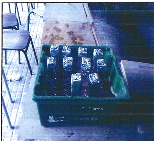
Photo III-7 : Eprouvettes d'essai de l'absorption capillaire recouvertes avec du papier d'aluminium
