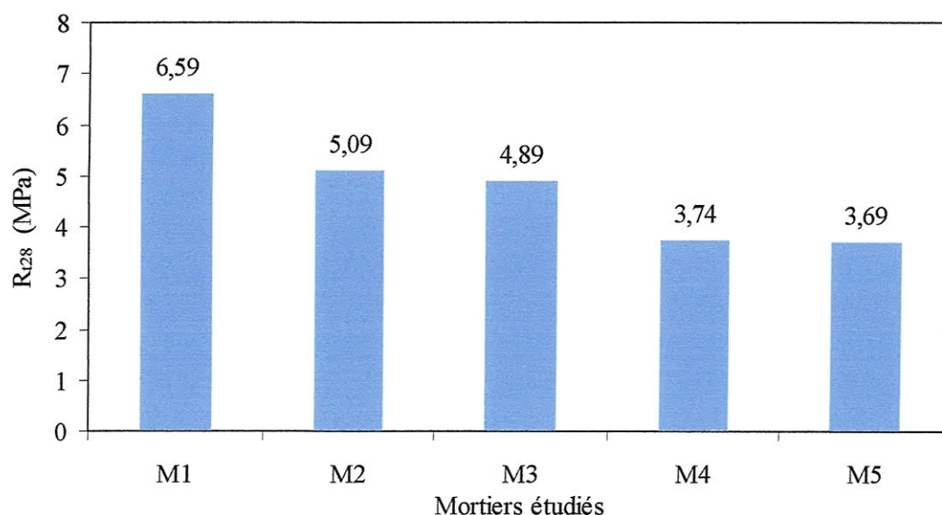
Figure IV-9 : Résistance à la traction à 28 jours des mortiers étudiés
