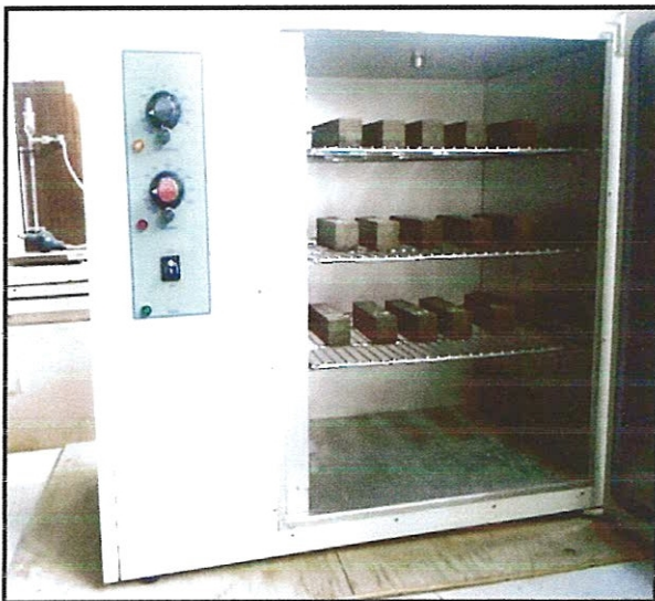
Photo III-6 : Conservation des éprouvettes dans l'étuve
