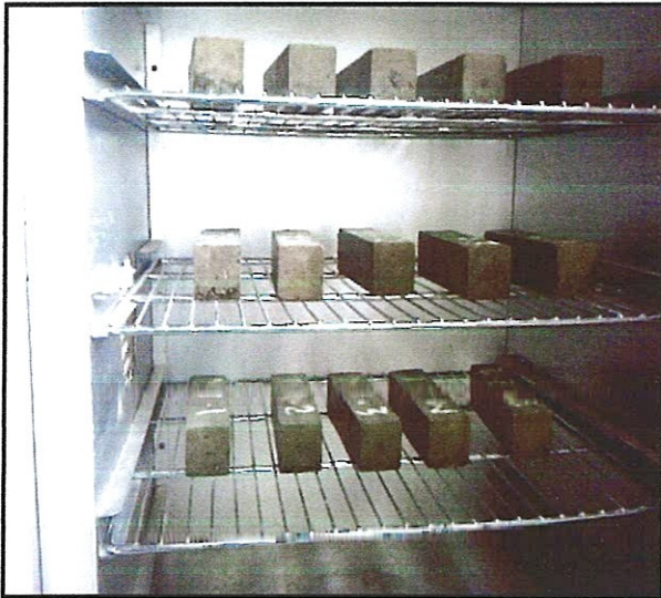
Photo II-5 : Séchage dans l'étuve et mouillage par immersion totale dans le bac à eau
