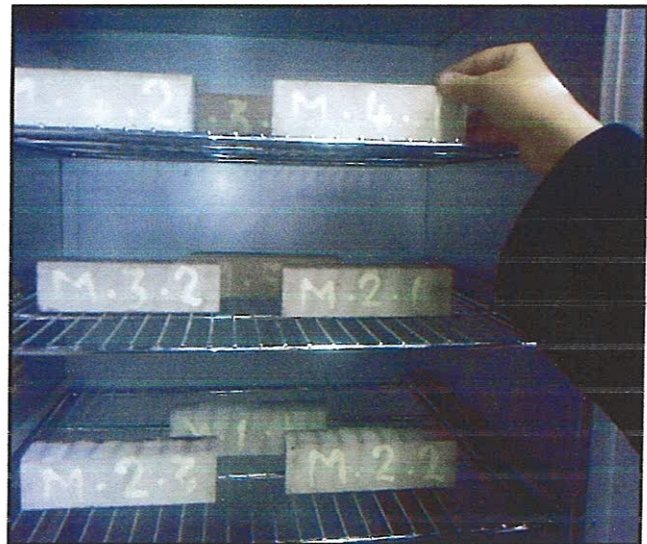
Photo III-6 : Conservation des éprouvettes dans l'étuve
