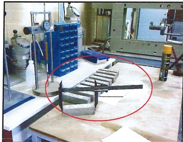
Photo II-4 : Mesure du retrait et gonflement par l'intermédiaire d'un pied à coulisse
