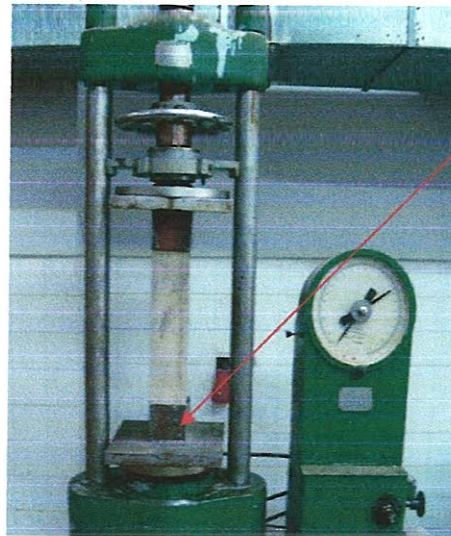
Figure 2.22 : Essai de compression du spécimen de 60 cm avec la solution des boîtes métalliques.
