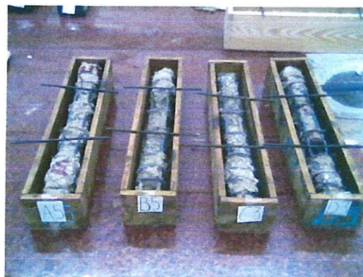
Figure 2.29 : Technique 5, section de 10 \times 10 avec gainage en micro béton.
