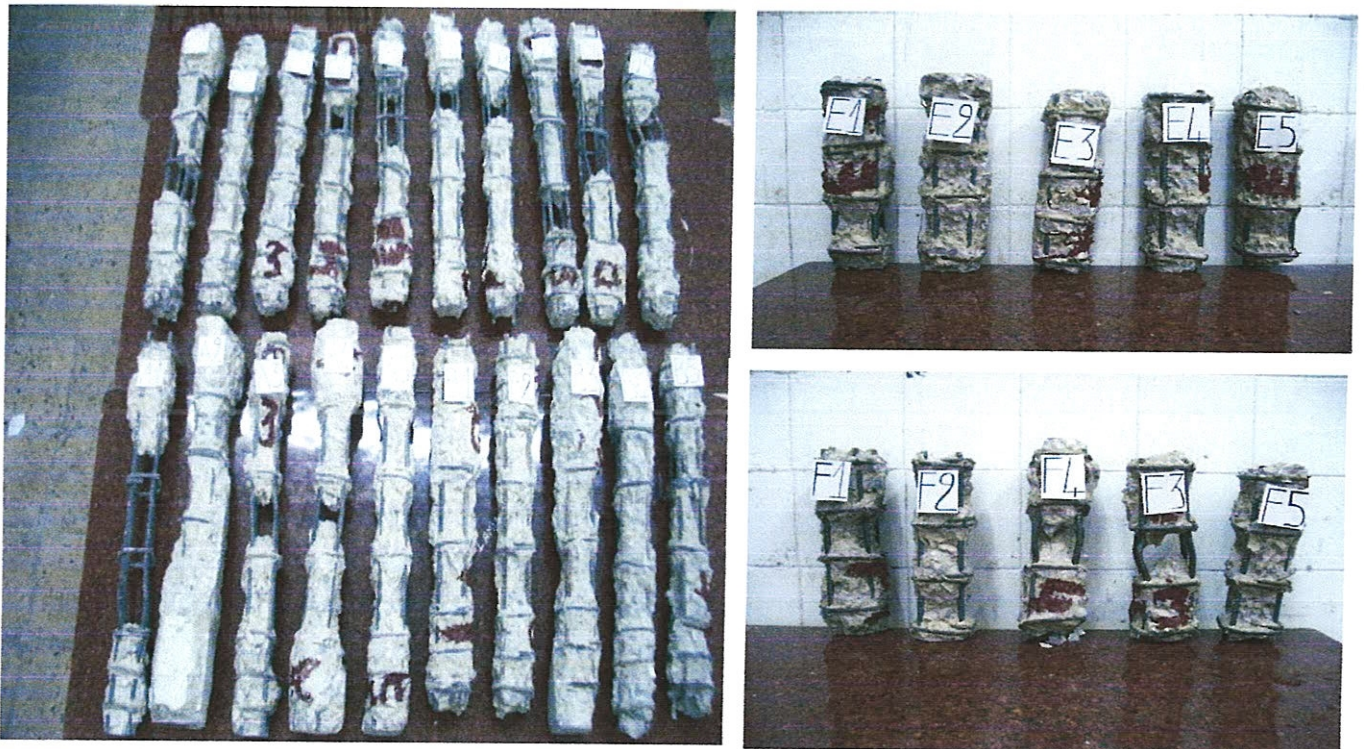
Figure 2.32 : Préparation des surfaces des spécimens avant renforcement.
