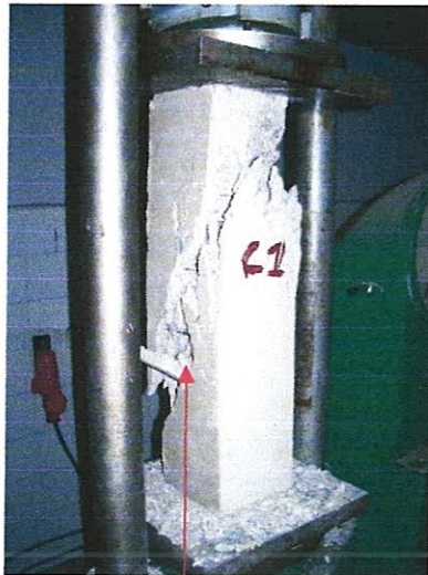
Détachement du béton d'enrobage au noyau ferrailé
