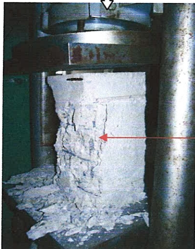
Destruction du béton d'enrobage
