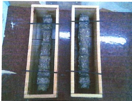
Figure 2.26 : Technique 2, section 15 \times 15 avec gainage en béton.
