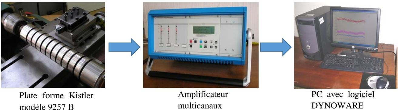
Fig. II.6 Chaîne de mesure des efforts de coupe.
