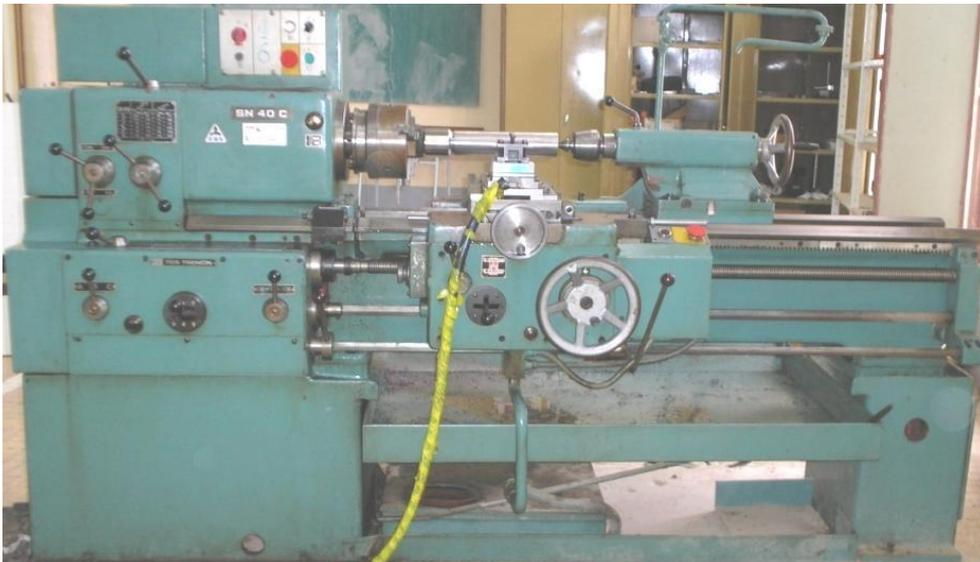
Fig. II.2 Tour parallèle modèle SN 40C
