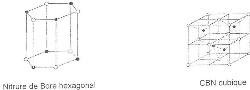
**Figure I-12:** Forme de la liaison chimique du CBN
