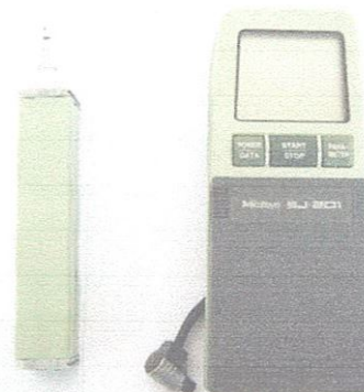
Figure II-10 Mesure de rugosité sans démontage de la pièce.
