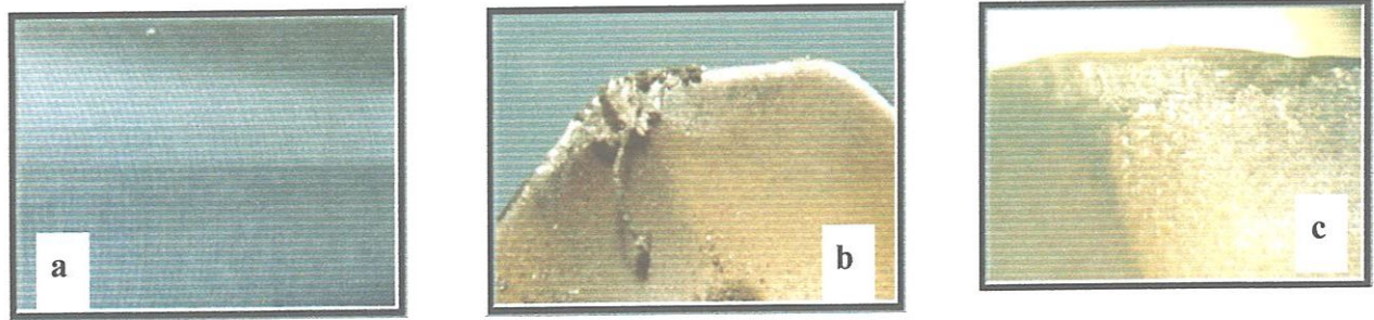
Fig. III-60 : Rugosité de la surface usinée pour ( L_c=12060\text{mm} ), V_c=111\text{m/min} ; f_z=0,22\text{mm/dent} ; a_p=0,6\text{mm} .
