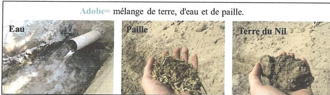
*Fig.25 : les matériaux composants de la terre utilisée dans la construction des maisons*
