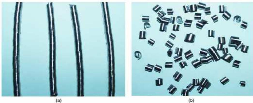
**Fig.I-35: (a) Génération de copeau lors de l'usinage sous pression de 150 bar. (b)Copeau fragmente lors de l'usinage avec pression de 203 bars [EZU 04].**
