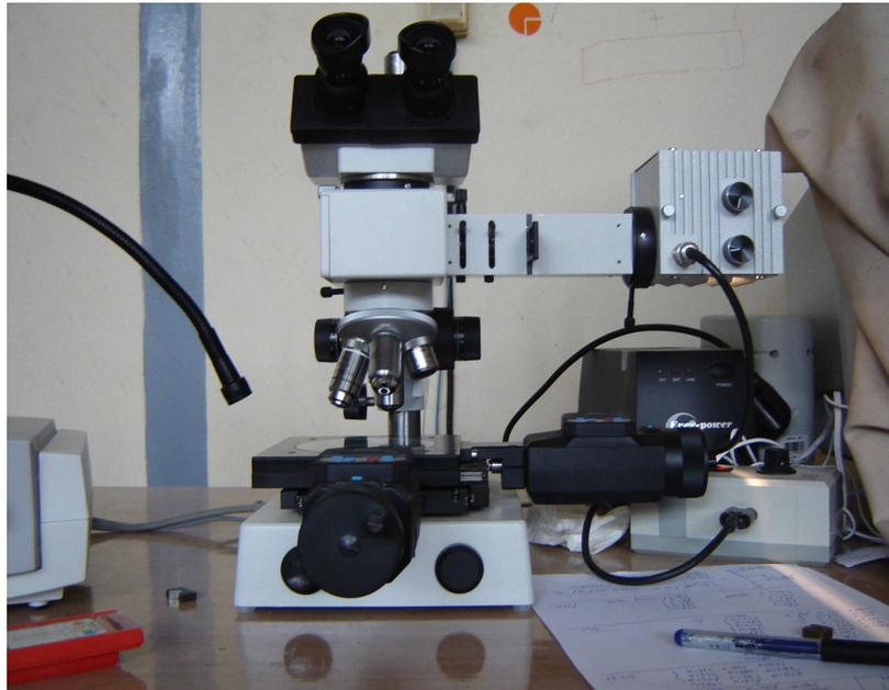
**Fig.II-3 : Microscope pour la mesure de l'usure**
