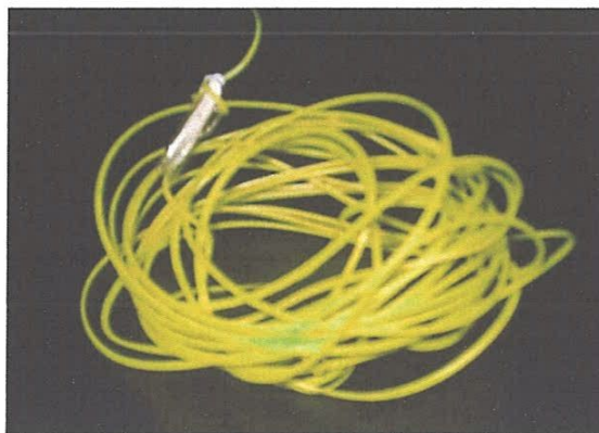
Figure 2.1 Filament en polyéthylène haute densité usiné dans la direction radiale d'un tube de gaz de diamètre 125mm
