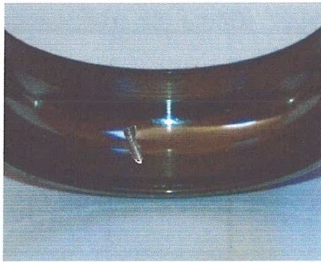
Fig. III.5 : Défauts sur la bague extérieure
