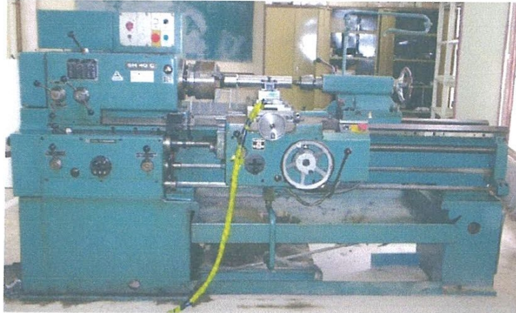
Figure II-1 Tour parallèle modèle SN 40 C.
