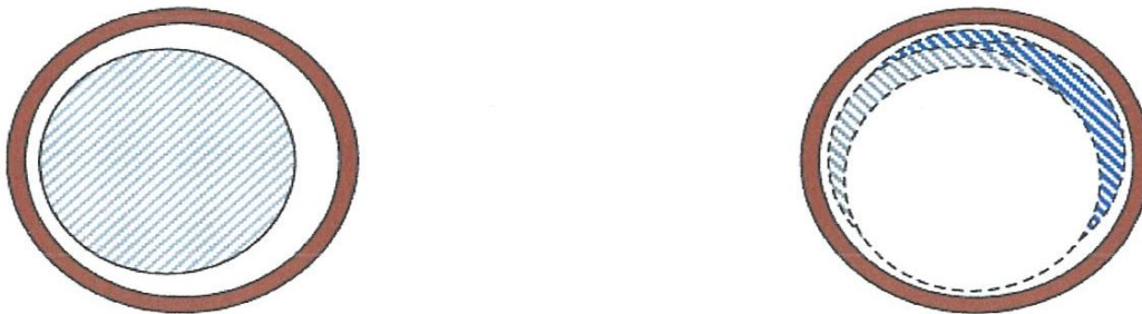
Figure13: Excentricité statique et Excentricité dynamique
