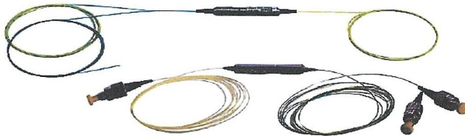
***Figure I.7 :*** Les circulateurs optiques
