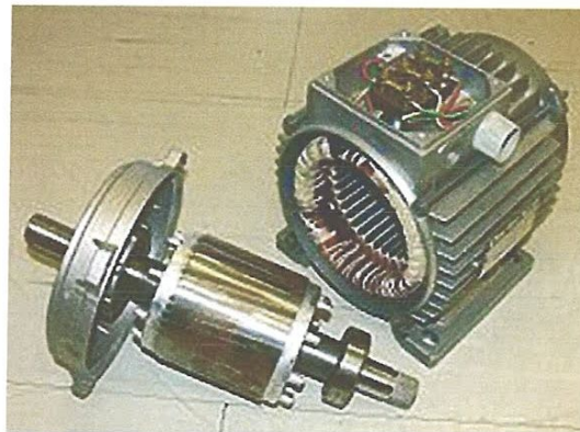
Figure (I.1) : Rotor (à gauche) et stator (à droite) d'une machine asynchrone 0,75 kW.
