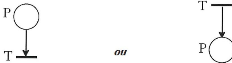
Figure. 2.1. Un Réseau de Petri (RdP).
