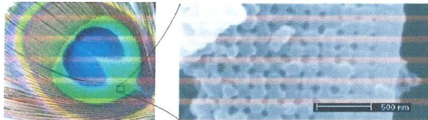
Figure. I.2. Plume de paon. L'encadré de droite est une image prise au microscope électronique à balayage (MEB) de la coupe d'une barbule verte. La structure de cristal photonique 2D est composée de piliers de mélanine liés par de la kératine ainsi que de trous d'air.
