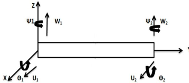
Figure 2.11 Élément poutre à 4 d.d.l
