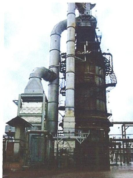
Fig. III-2 : Colonne distillation sous vide
