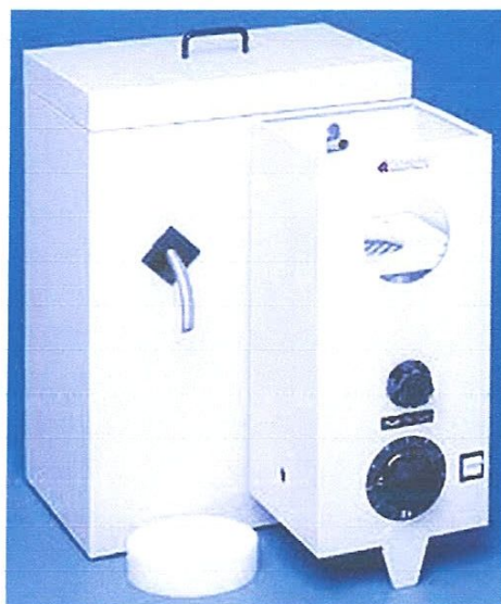
Figure III.1. Schéma d'un distillateur utilisé dans la distillation des carburants
