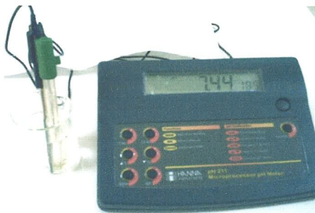
Figure III.12 : pH mètre et Type (HANAA, PH211).
