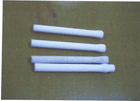
Figure III.6 : Préparation des membranes poreuses avec ajout d'agent porogène
