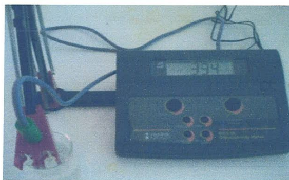
Figure III.13 : conductimètre de type HANNA – EC215.
