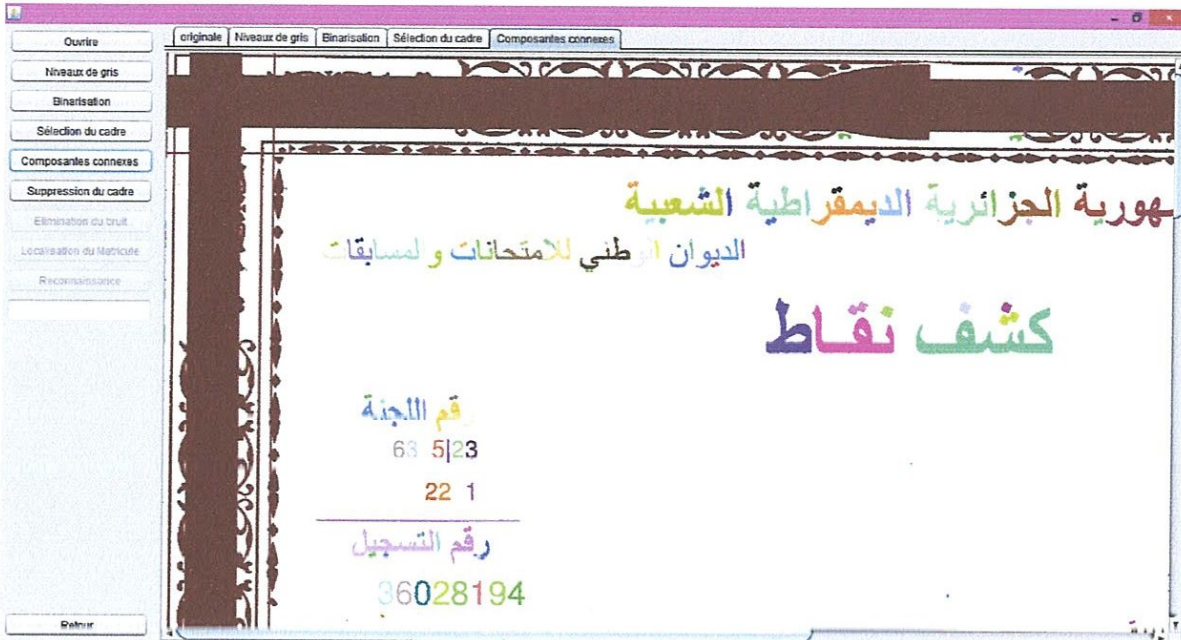
Figure IV.9 : Etiquetage des composants connexes.
