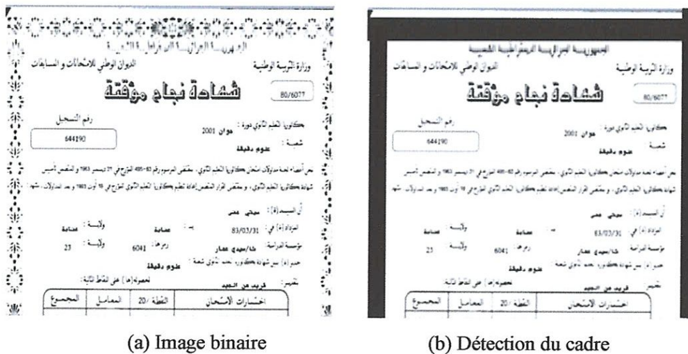
Figure III.5 : Détection de la bordure.
