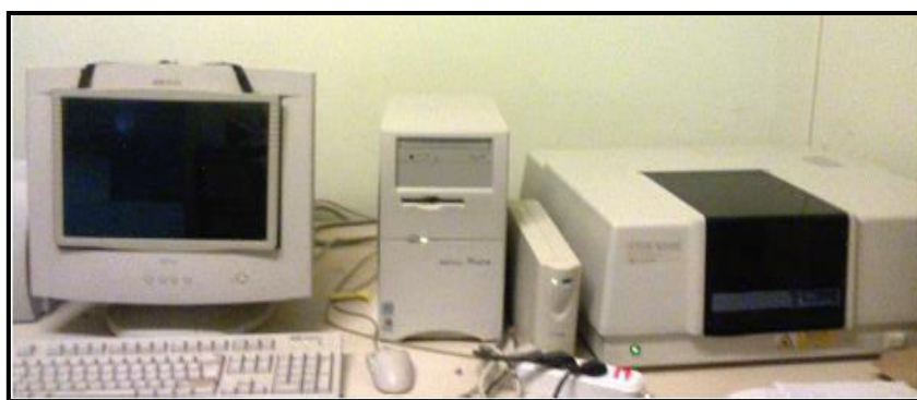
Figure III.6: Spectromètre infrarouge à transformée de Fourier de marque Shimadzu de type FTIR-8000 séries
