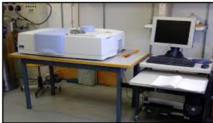
Figure III.9: Spectrophotomètre UV-Vis de marque Perkin Elmer de type Lambda 950 UV-Vis-NIR
