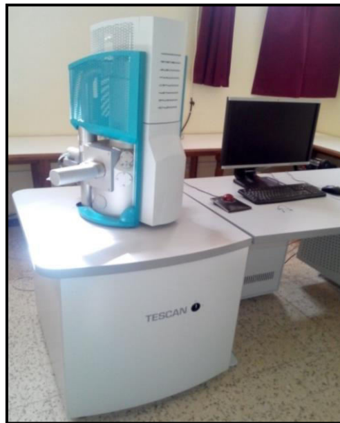
Figure III.7: Microscope électronique à balayage de marque Tescan de type Vega 3
