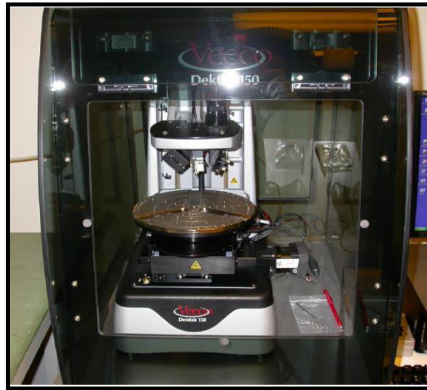
Figure III.3: Profilomètre de marque Veeco (Brüker) de type Dektak 150
