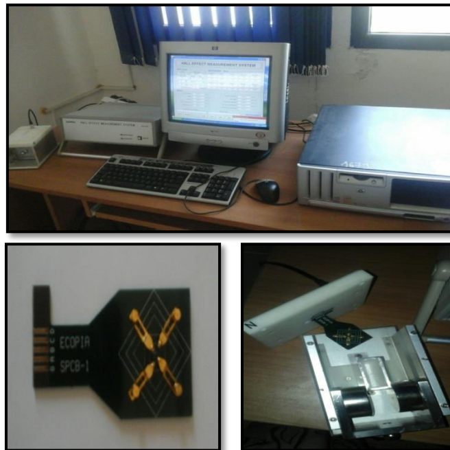
Figure III.12: Dispositif des mesures électriques par effet Hall
