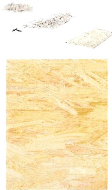
Figure 2.12 : principe de fabrication de l'OSB
