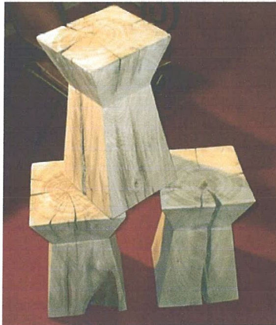
Figure 1-5: fissures radiales de retrait
