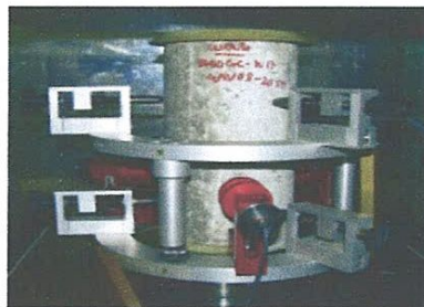
Figure 18 : Cage extensométrique utilisée pour la détermination du module d'élasticité.
