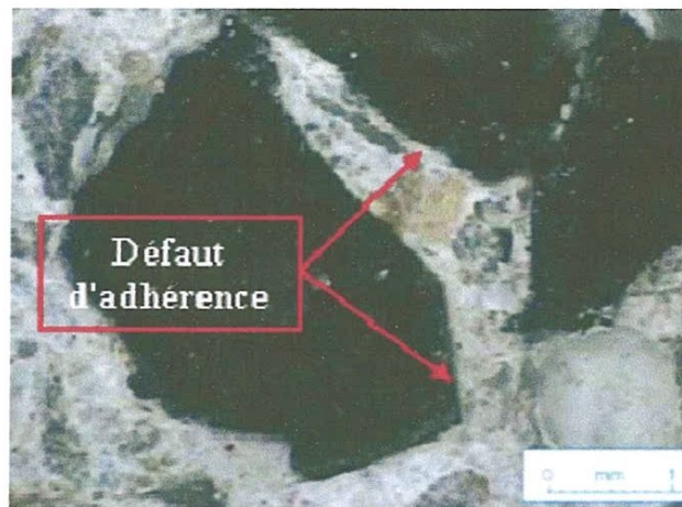
Figure 17 : Défaut d'adhérence entre le caoutchouc et la matrice cimentaire vu au vidéo-microscope,
