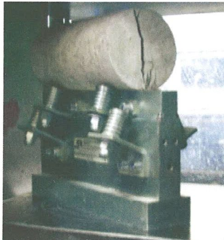
Figure 20 : Eprouvette cylindrique reposant sur le support dédié après l'essai de traction indirecte par fendage.
