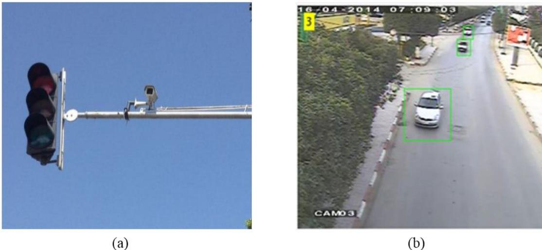
FIGURE 1.5 – (a.)Caméra vidéo installé par notre équipe LAIG au niveau d'intersection à Guelma (b.) Exemple de détection et de comptage de véhicules
