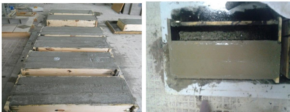
Figure II.14 : Bétonnage des éprouvettes.
