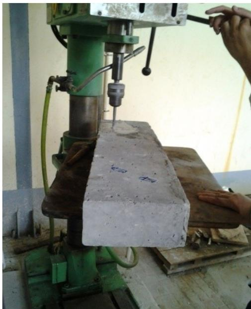
Figure II.17 : Réalisation des trous à l'aide d'une perceuse électrique.
