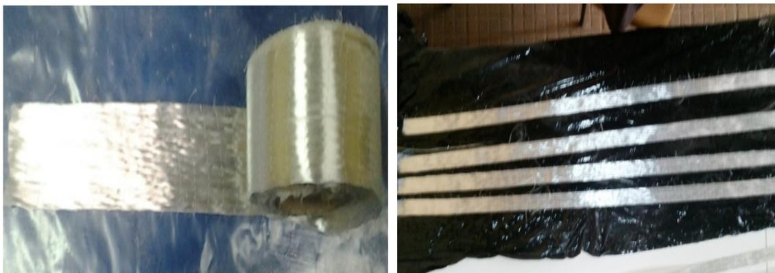
Figure II.7 : Tissu de fibre de verre unidirectionnel.
