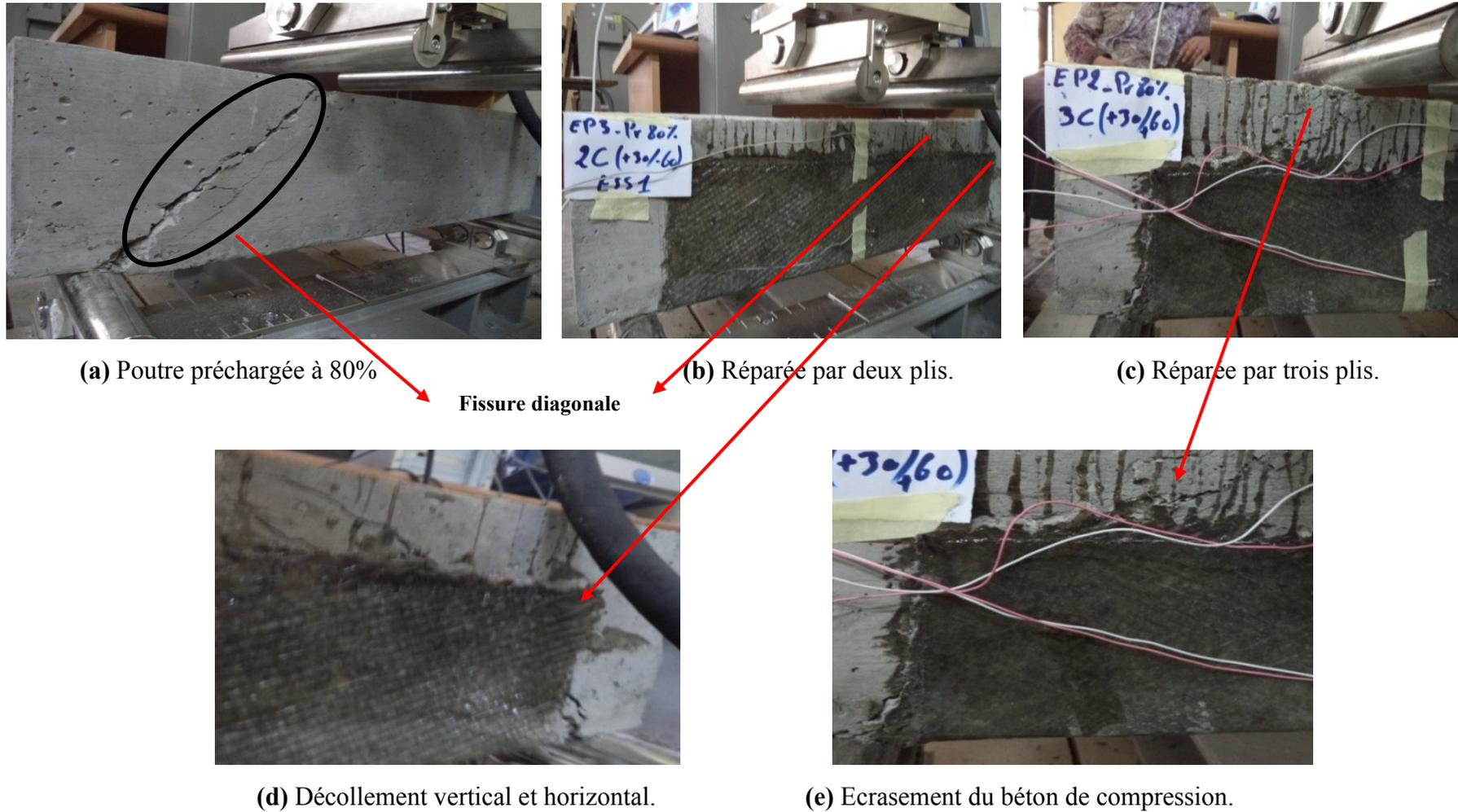
Figure III.18 : Modes de rupture des poutres préchargées à 80% puis réparées par le composite TFV1.
