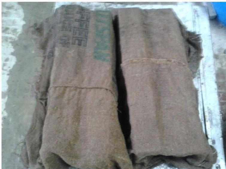
Figure II.15 : Processus de cure sous jute humide
