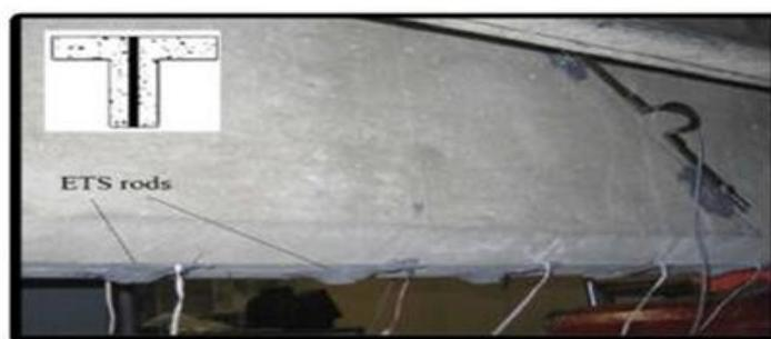
Figure I.15.: Poutre renforcée avec la méthode ETS Tirée de [CHA-11].
