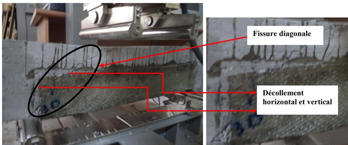
Figure III.7 : Endommagement de la poutre renforcée par TFV1 (EP\_NP\_30/60).
