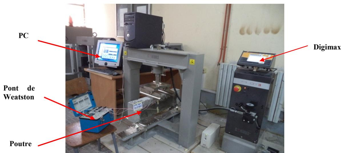
Figure II.10 : Machine d'essai de flexion.
