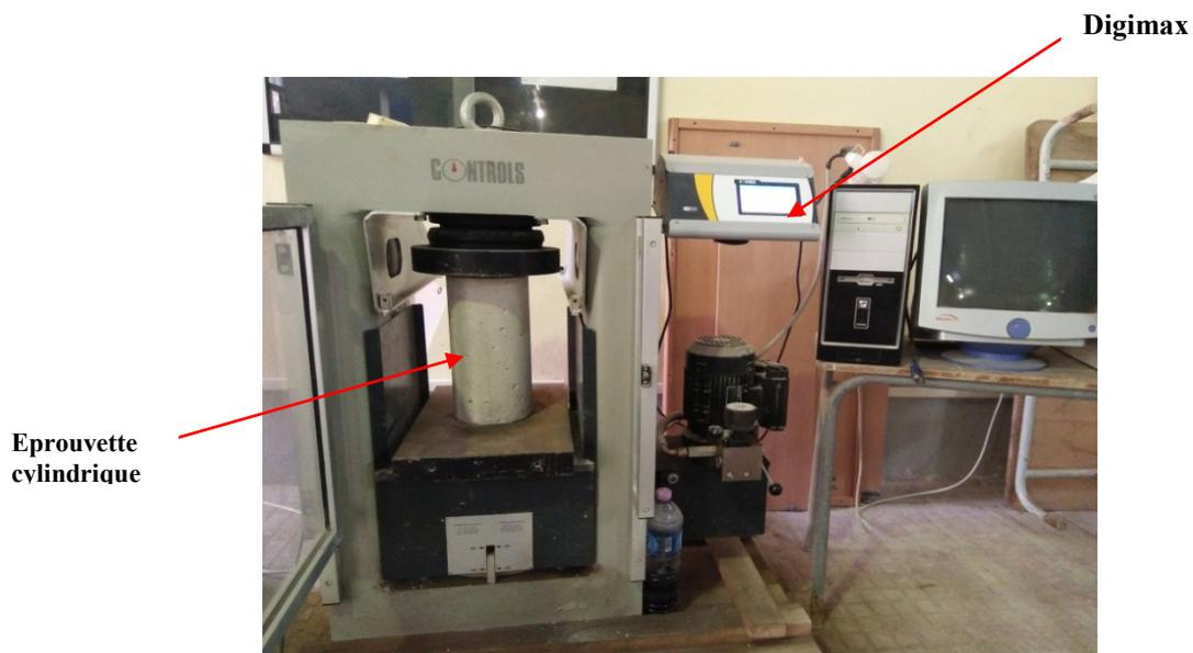
Figure II.9 : Machine de l'essai de compression.
