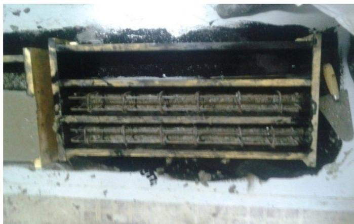
Figure II.13 : Coffrage des éprouvettes.
