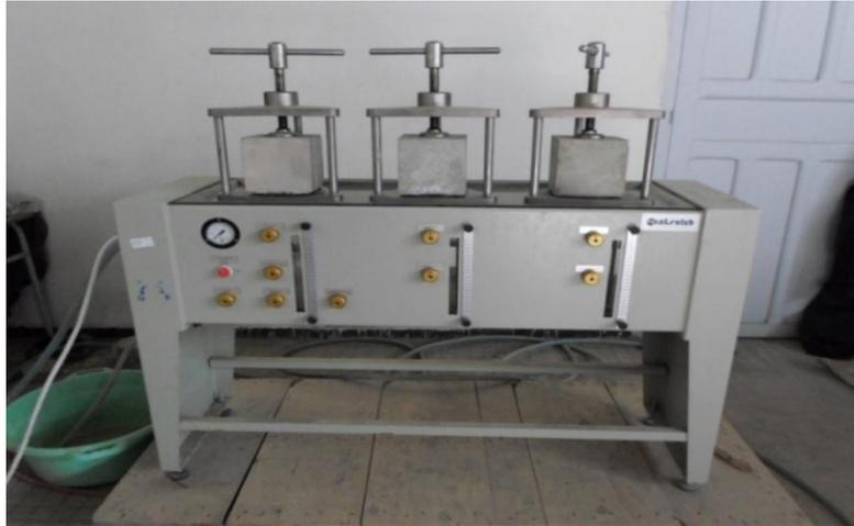
**Figure IV.8.** Dispositif utilisée pour le calcul de la pénétration de l'eau
