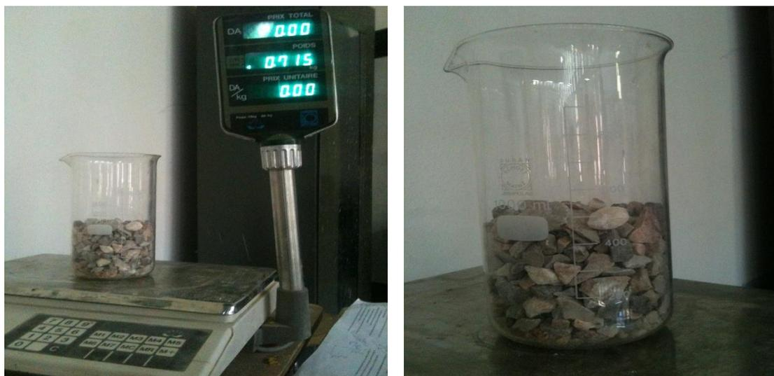
**Figure III.1.** Procédé utilisé pour la mesure de la masse apparente du gravier
