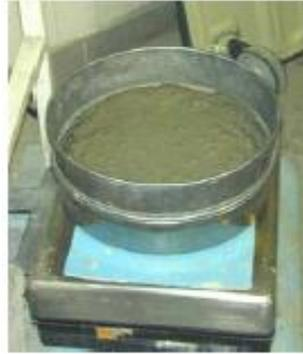
**Figure I.17.**Essai de stabilité au tamis. [6]
