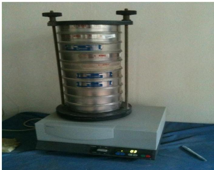
**Figure III.4.** Analyse granulométrique
