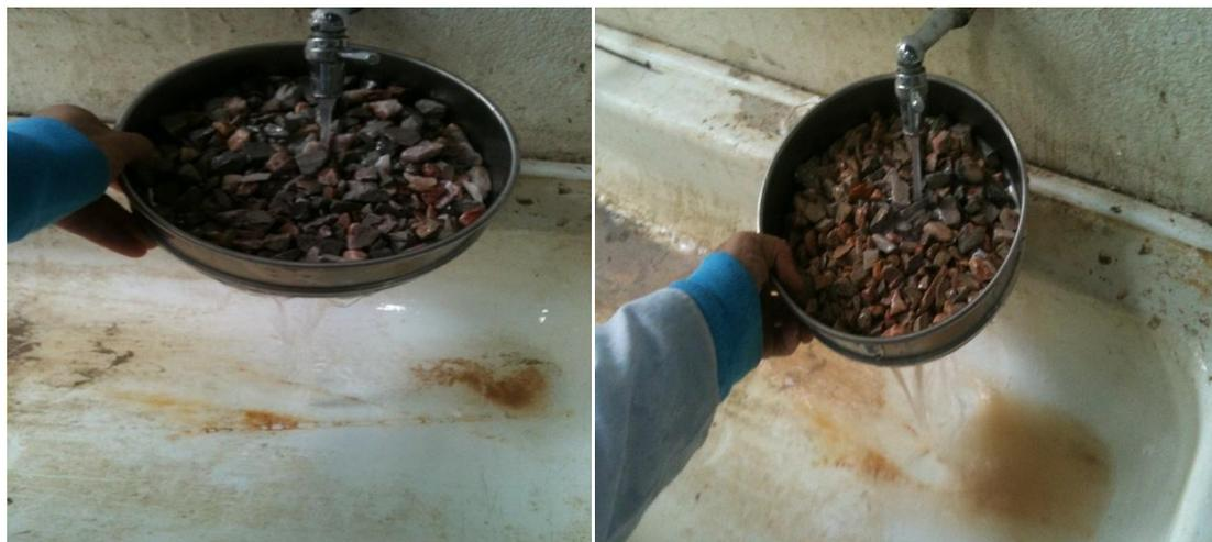
Figure III.3. Mesure de la propreté des graviers
