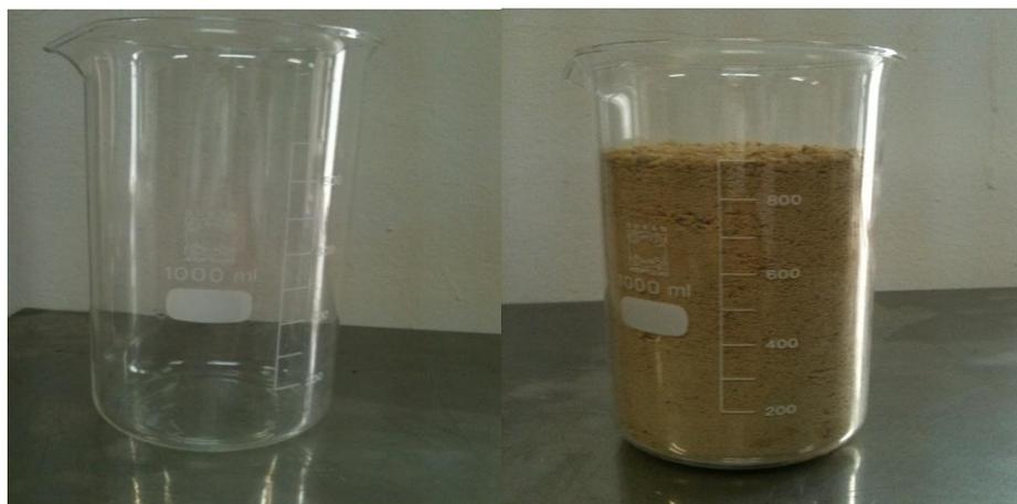
Figure III.6. Mesure de la masse volumique apparente du sable
