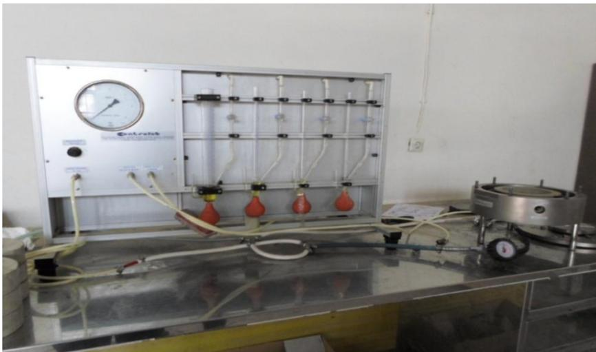
**Figure IV.7.** Dispositif utilisée pour le calcul de la perméabilité à l'air (compte-bulles)
