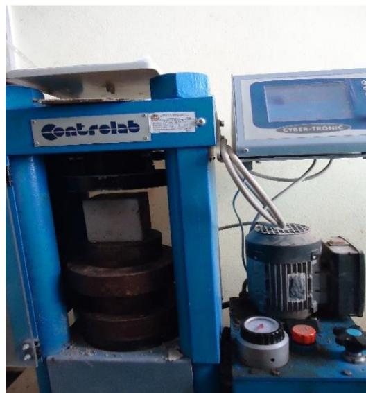
Figure IV.4. Presse de compression utilisée
