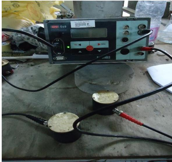
**Figure IV.6.** Appareillage d'ultrason utilisé (CONTROLS)
