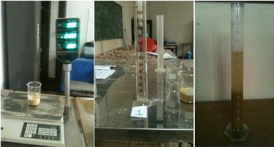
Figure III.7. Mesure de la masse volumique absolue du sable
