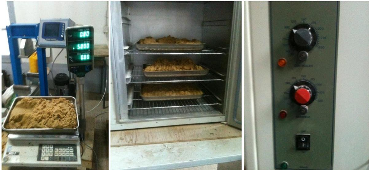
**Figure III.9.** Détermination de la teneur en eau
