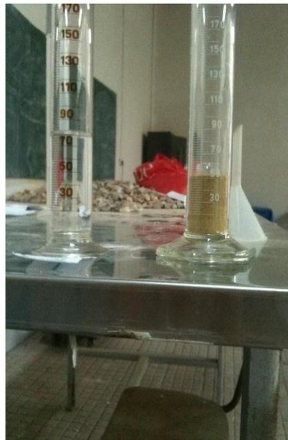
**Figure III.8.** Mesure de la compacité du sable
