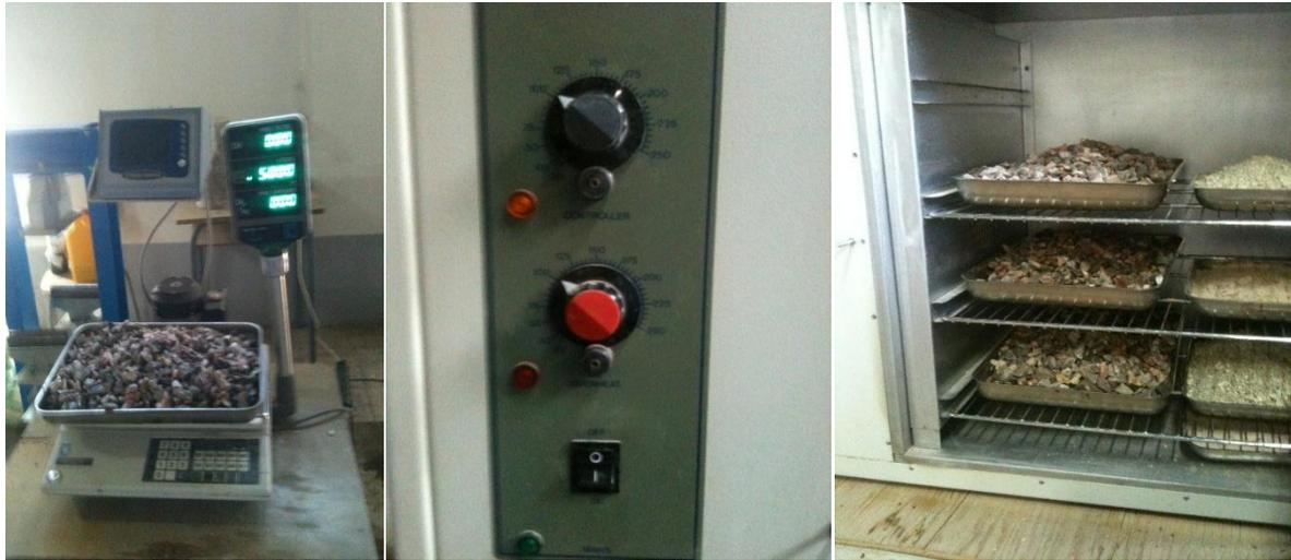
**Figure III.2.** Détermination de la teneur en eau
