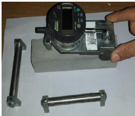
Figure 3-9: Mesure du retrait libre par un rétractomètre digital
