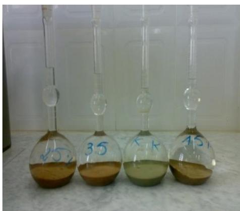
Figure 3-6: mesure de la masse volumique absolue des ciments
