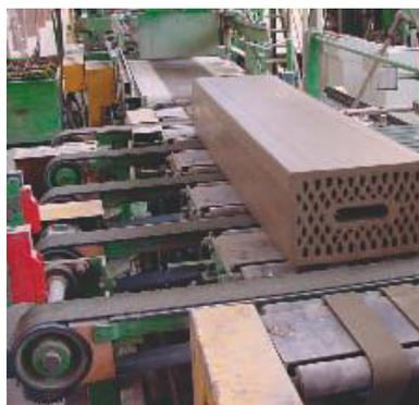
Figure 2-4: Façonnage de la brique [2]
