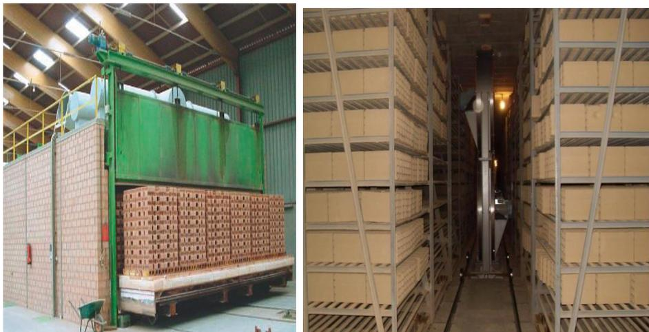
Figure 2-5: séchage de briques [2]
