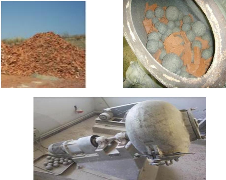
Figure 3-2: opération de broyage des déchets de brique
