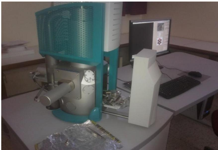
Figure 3-15: microscope électronique à balayage (MEB)
