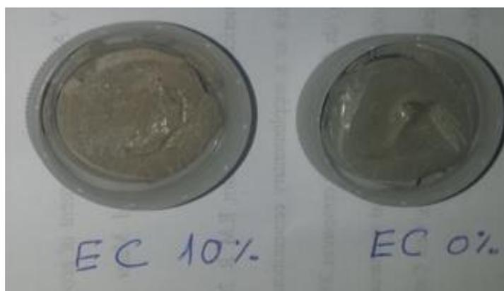
Figure 3-12: pâtes pures de ciment préparées avec ( $E/C=0,4$ ) pour les échantillons C0 et C10
