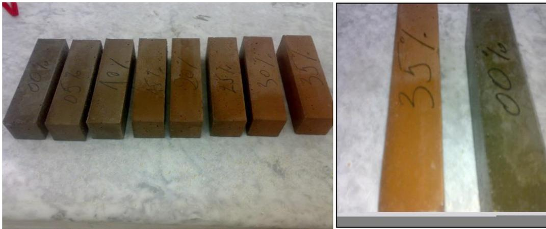
Figure 5-11: changement de couleur des mortiers de ciments contenant de 0 à 35% de brique
