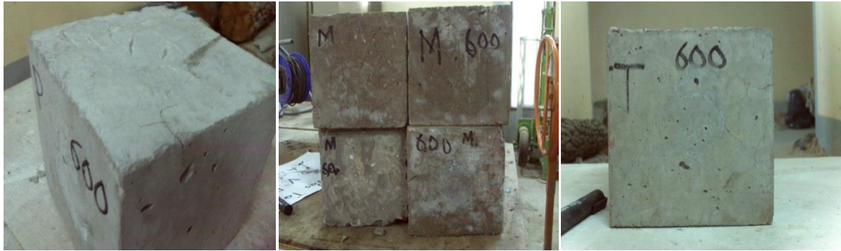
Figure IV.4. Apparition des fissures très visibles à 600°C
