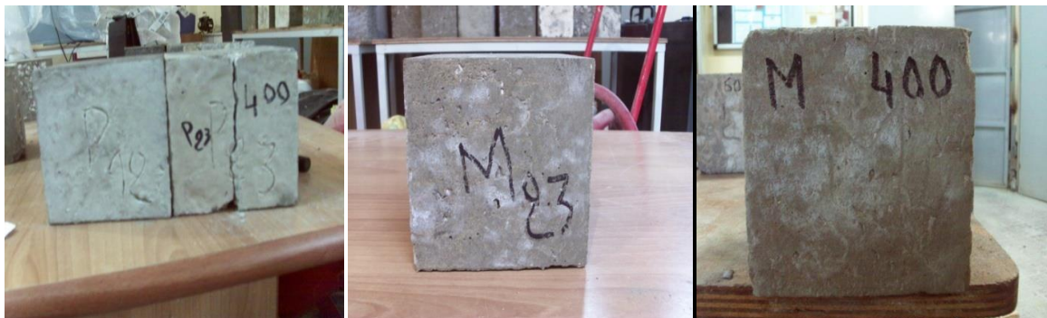
Figure IV.3. Changement de couleur à 400°C
