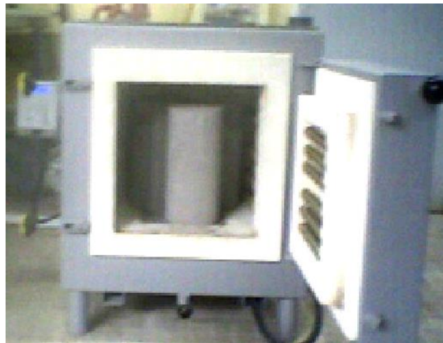
Figure III.8 : Four électrique utilisé.
