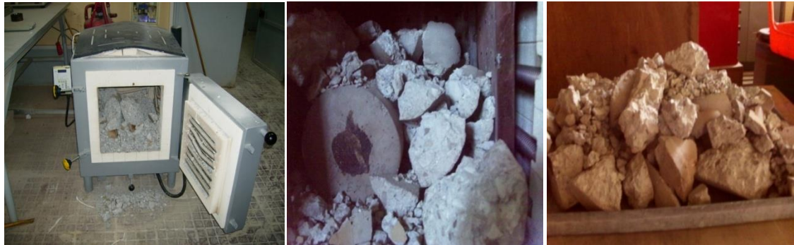
Figure IV.16. Eclatement explosif du BHP2 à 544°C
