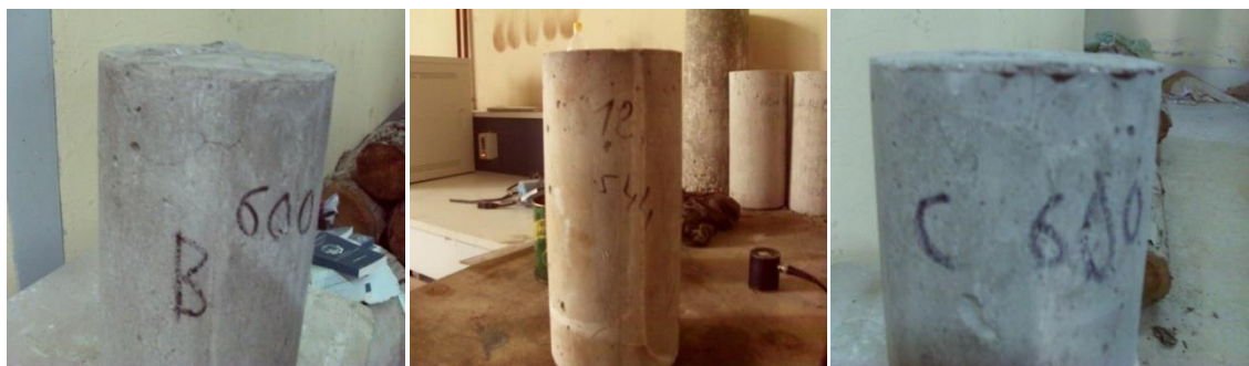
Figure IV.17. Apparition des fissures visibles à 600°C
