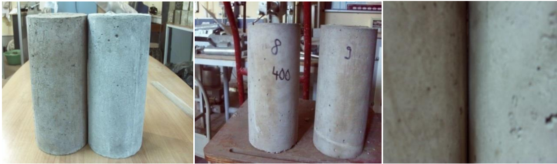
Figure IV.15. Changement de couleur à 400°C
