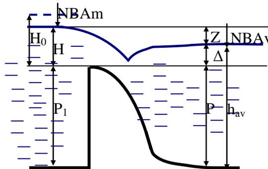
**Fig. (6.30) : Déversoir rectangulaire noyé à seuil normal**
