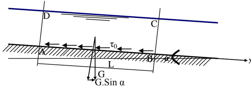
**Fig.2-2: Schéma représentatif d'un volume de liquide en écoulement uniforme**
