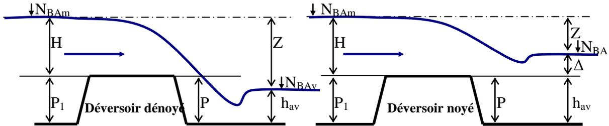
**Fig. (6.16) : Schémas approximatifs des deux déversoirs dénoyé et noyé**
