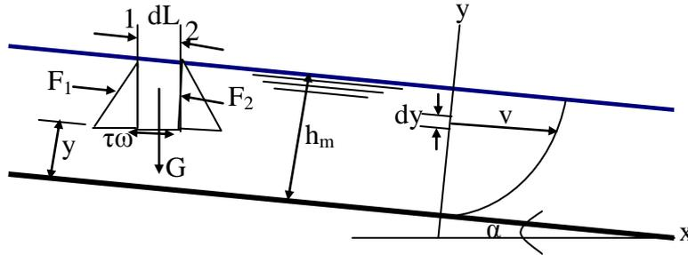
**Fig.2-3: Répartition verticale de la vitesse dans un canal (cas du régime laminaire)**
