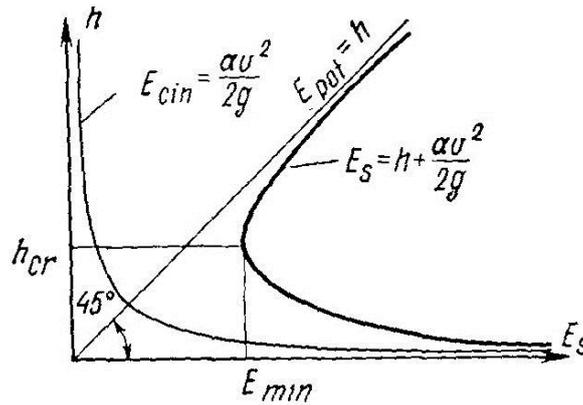
**Fig. 3-4: Variation de l'énergie spécifique cas d'un canal à débit constant**
