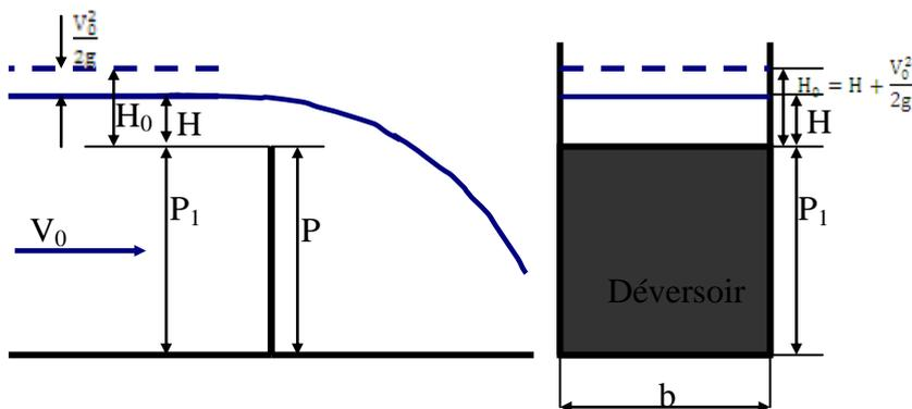
**Fig. (6.17): Les paramètres d'un déversoir rectangulaire dénoyé en mince paroi**
