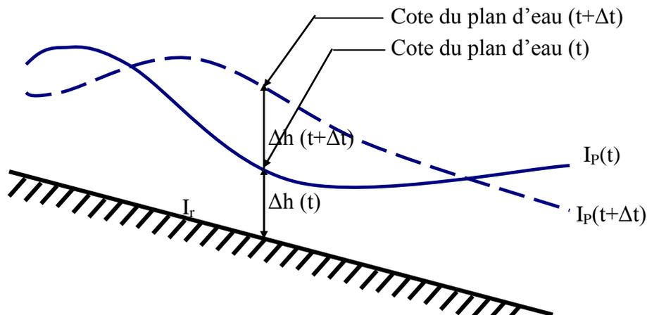
Fig. 1.10 : Écoulement non permanent
