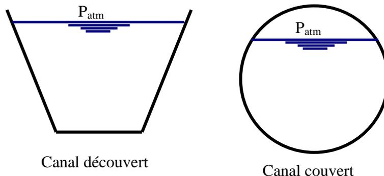
**Fig. 1.3 : Types de canaux artificiels**
