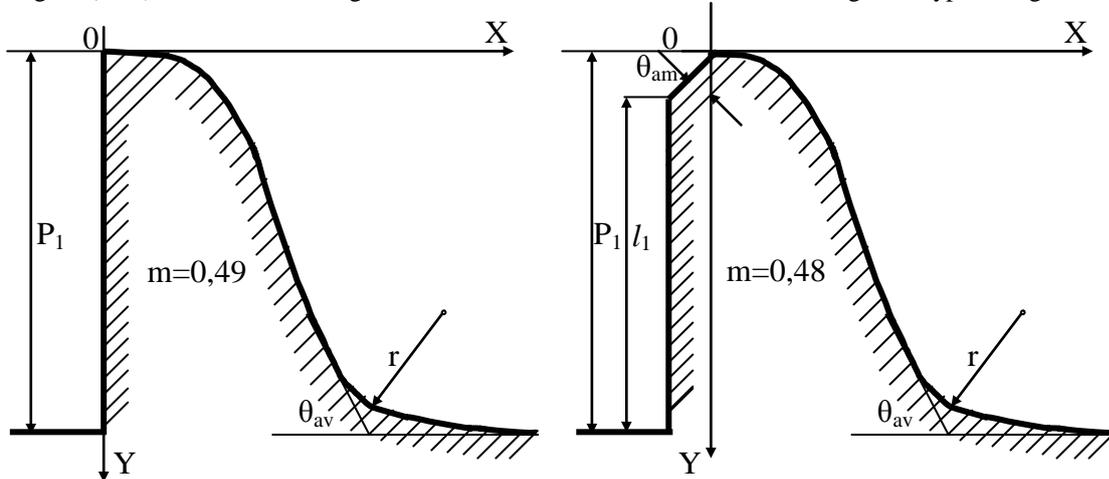
**Fig. (6.28) : Déversoir à seuil normal de type Creager-Ofitsérov**
