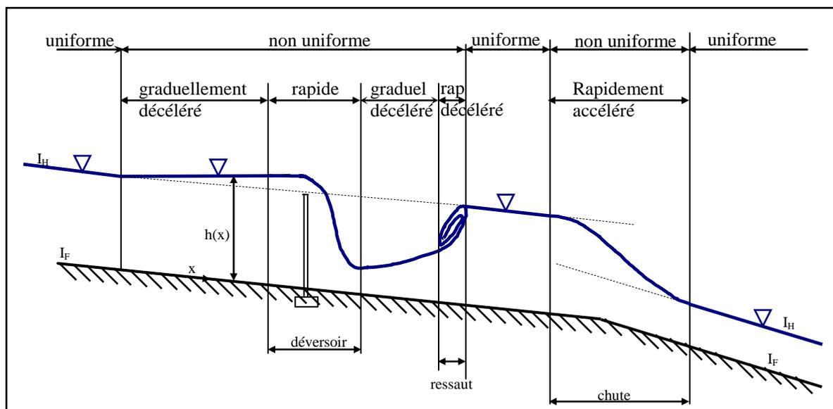
**Fig. 1.11 : Variabilité des écoulements dans l'espace**
