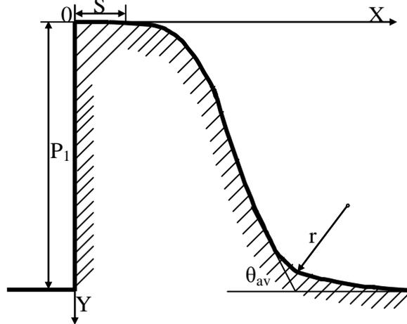
**Fig. (6.29) : Déversoir à seuil normal avec une arête horizontale sur la crête**
