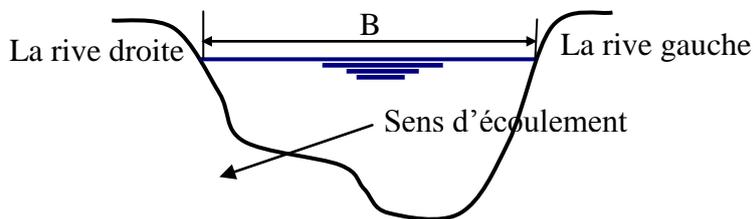
**Fig .1.7: La largeur superficielle d'un canal**
