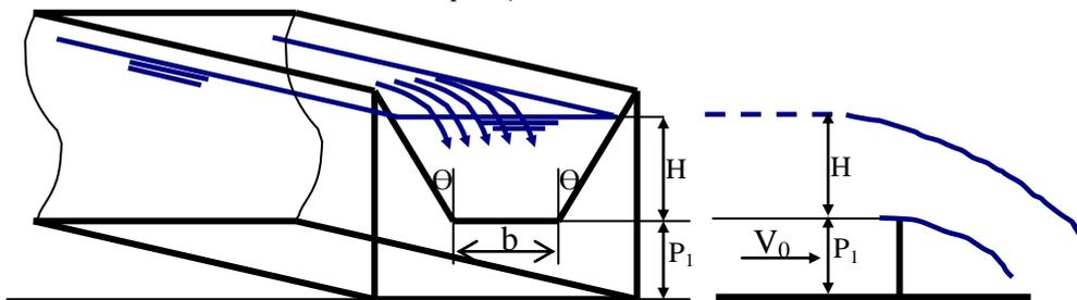
**Fig. (6.23) : Déversoir trapézoïdal dénoyé sans contraction latérale**
