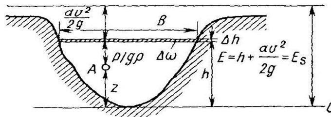
**Fig. 4-1 : Représentation de l'énergie spécifique dans un canal naturel**
