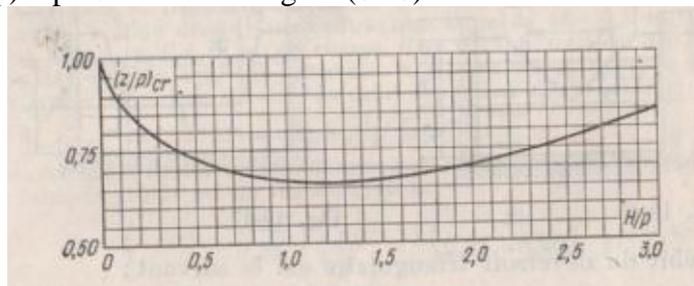
**Fig. (6.20) : L'abaque de la chute relative  $(z/p)_{cr}$  en fonction du rapport  $H/P$**
