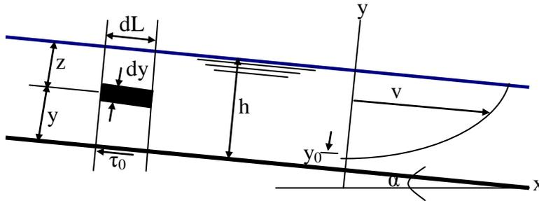
**Fig.2-4: Répartition verticale de la vitesse dans un canal (cas du régime turbulent)**
