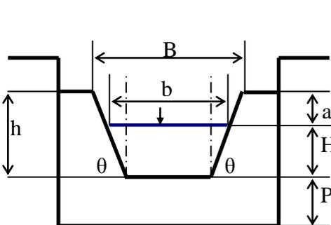
Fig. (6.6): déversoir trapézoïdal
