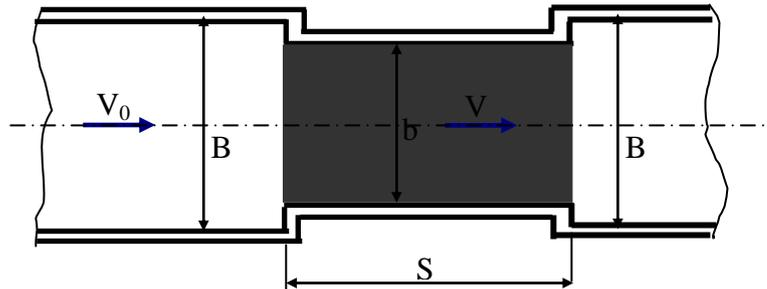
**Fig. (6.26) : Déversoir à large seuil avec contraction latérale**
