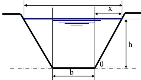
**Fig. 1 : Canal trapézoïdal**
