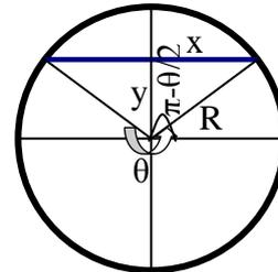
Quand  $\theta = 2\pi$  (forme circulaire)  $\Rightarrow \omega = \pi R^2$  et  $\chi = 2\pi R$  **Fig.2-10: canal circulaire**
