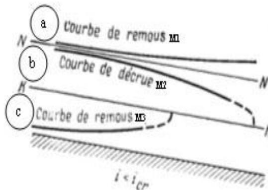
**Fig.4-6 : Les différentes courbes de types M**
