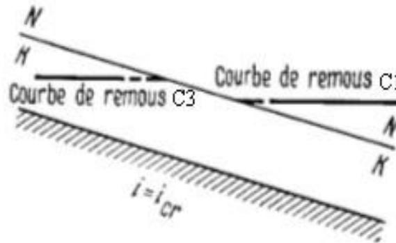
**Fig.4-8: Les différentes courbes de types C**
