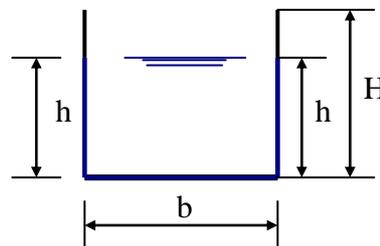
**Fig .1.5 : Le périmètre mouillé d'un canal à section transversale rectangulaire**
