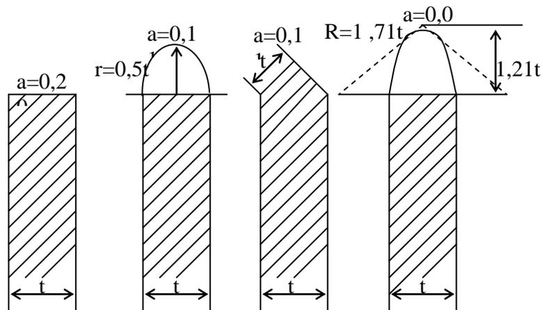
**Fig.(6.32) : Forme des abutements et des piles**
