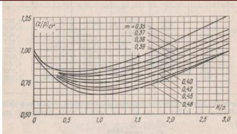
**Fig.(6.31): L'abaque  $(z/p)_{cr}$  en fonction du rapport  $(H/P)$  cas d'un canal à seuil normal**
