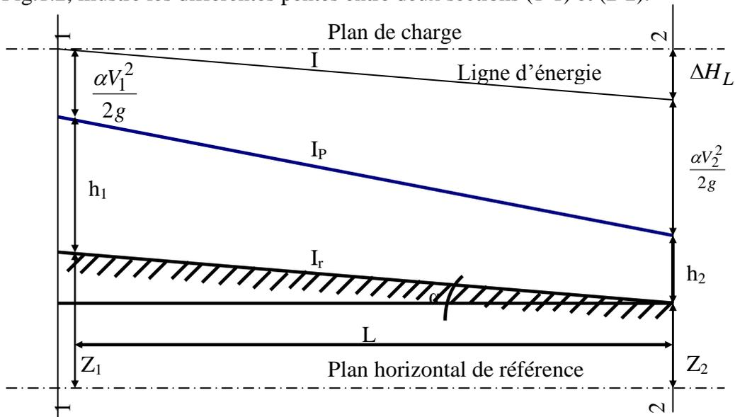
**Fig.1.8 : Présentation graphique des différentes pentes en hydraulique**
