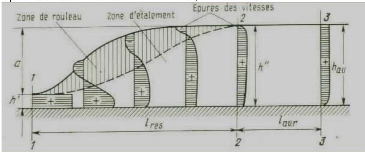
**Fig. 5-1 : Ressaut hydraulique**
