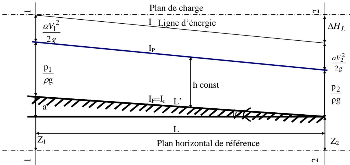
**Fig.2-1: Ecoulement uniforme dans un canal prismatique**
