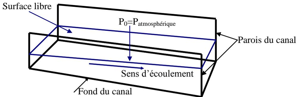
**Fig. 1.1 : Schéma représentatif d'un canal**
