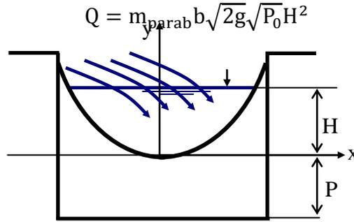
**Fig. (6.24) : déversoir parabolique dénoyé sans contraction latérale**
