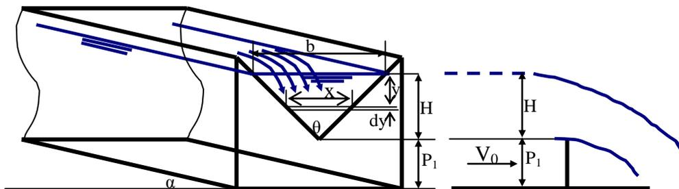
**Fig. (6.22) : Déversoir triangulaire dénoyé sans contraction latérale**
