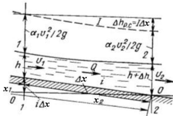
**Fig.4.2:Présentation graphique de l'équation d'énergie en écoulement graduellement varié**
