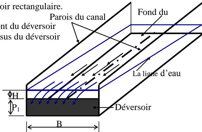
**Fig. (6.1): Déversoir rectangulaire en mince paroi placé dans un canal rectangulaire**
