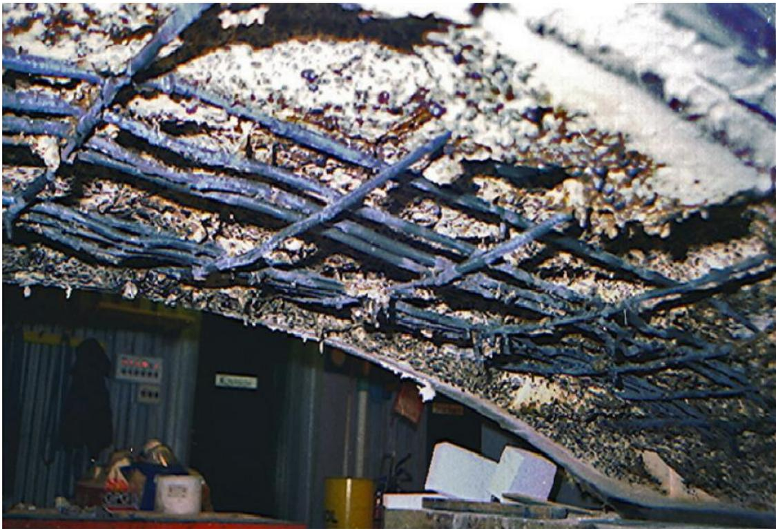
**Figure 3.1** Écaillage d'un élément du tunnel de Great Belt testé à l'Institut de recherche technique de Suède. [JANS, 2013].
