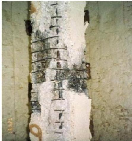
**Figure 3.5** Détachement du béton des angles d'un poteau testé au laboratoire [KODU, 2007].
