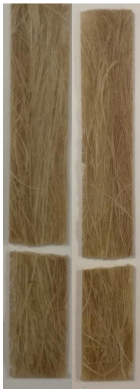
Figure IV.13 : Faciès de rupture des éprouvettes bio-composite sollicités en traction monotone.
