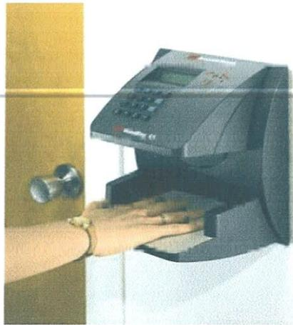
**Figure (1.1) : Dispositif de reconnaissance par géométrie de la main**
