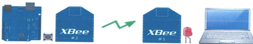
Fig. (II.12): Communication entre l'Arduino et l'ordinateur
