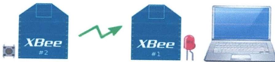
Fig. (II.11): Communication XBee vers un ordinateur
