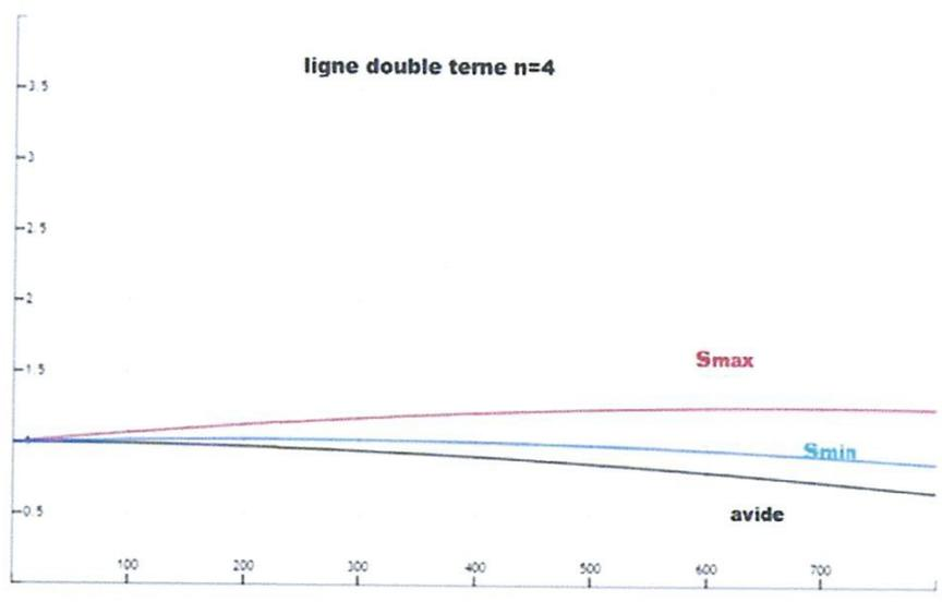
Figure II.3. Distribution de la tension de long de la ligne sans compensation
