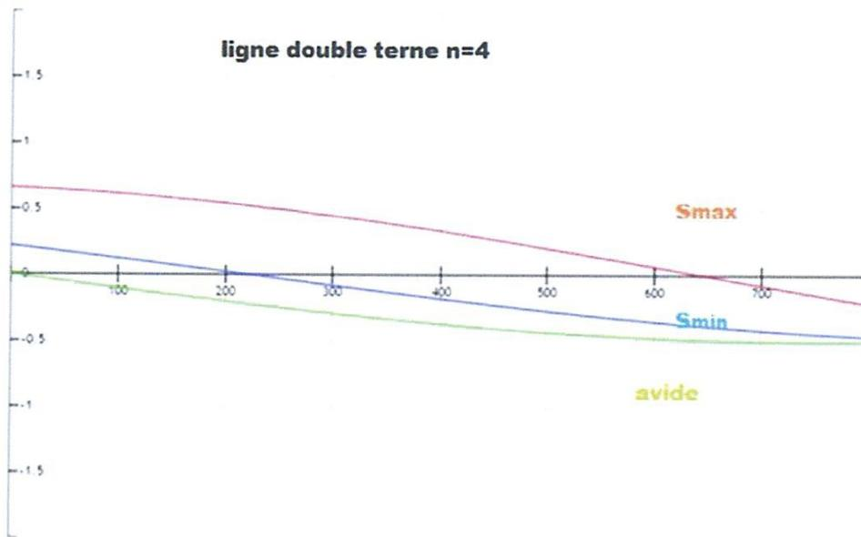
Figure .II.4. Distribution de la puissance réactive le long de la ligne sans compensation
