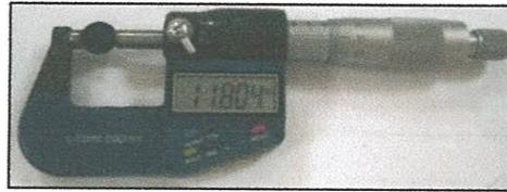
Figure III.8 : Micromètre électronique.
