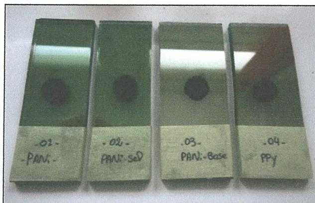
Figure IV.4: échantillons préparés (Pastille).
