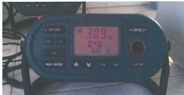
Figure III.3 : Image d'un conductimètre
