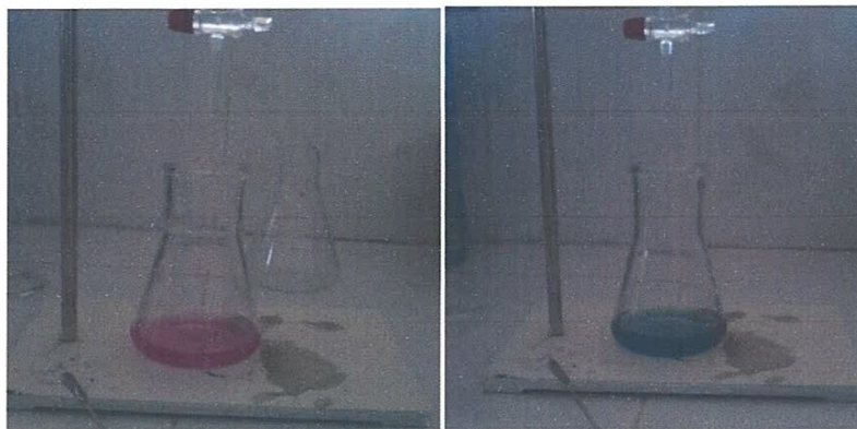
Figure III.4 : Virage de la couleur du rose au bleu pour la détermination du TH
