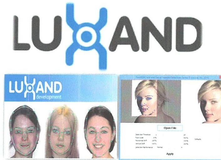
Figure IV.2 : Exemple d'extraction des points caractéristiques d'un visage en utilisant Face SDK.
