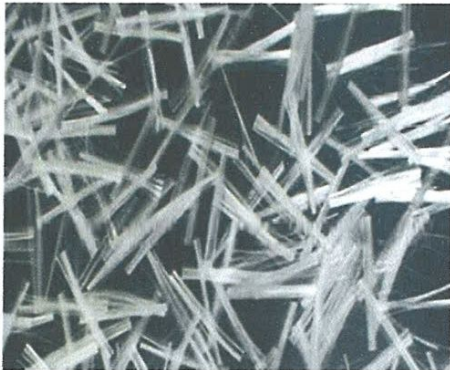
Figure II.1 : Fibres de verre types E hachées.
