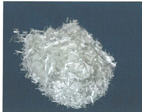
Figure II.1 : Fibres de verre types E hachées.
