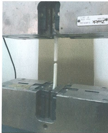
Figure III.4 : La tendance d'une éprouvette de PA66 pur lors de l'opération de traction.
