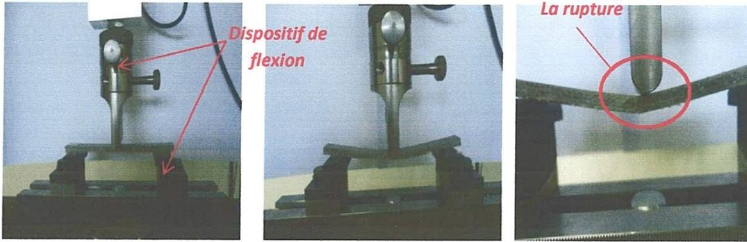
Figure III.21: Essai de flexion des éprouvettes en stratifiés jute/polyester.
