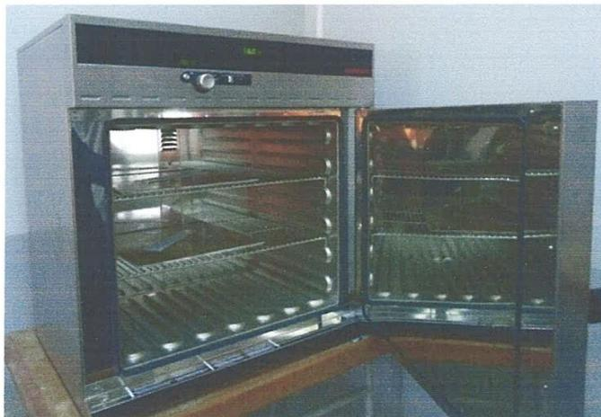
Figure II.6: L'étuve de séchage
