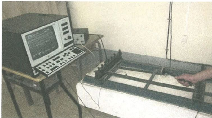
Fig. 1 : Dispositif utilisé pour la mesure des fréquences propres d'une poutre métallique
